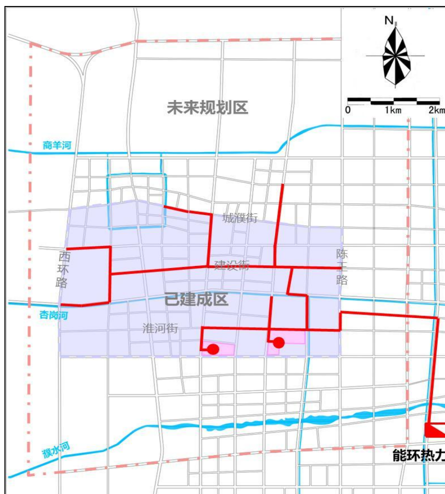
图 4-3 已有供暖管网平面布置图
