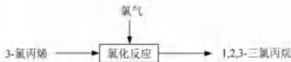
图 3.5-11 1, 2, 3-三氯丙烷产品工艺路线简图
